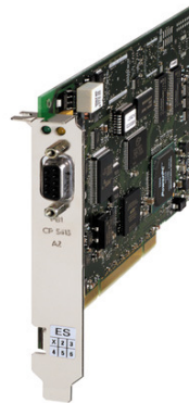
Figura 27 – CP5613 A2 (SIEMENS (e), 2008)
